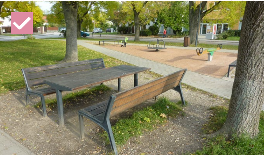
33 Príklad vhodného dizajnu sedenia so stolom, ktorého parametre poskytujú dostatok priestoru napr. pre užívateľov s kočíkmi. Je však potrebné dbať na riadne spevnenie povrchu pod takýmto sedením. Bratislava, Park pod lipami
